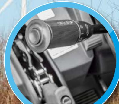
Fahrtrichtungsschalter mit 3 Vorwärtsgängen – Stapler erreicht Höchstgeschwindigkeit von bis zu 26 km/h
