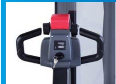
Ergonomischer Deichselkopf mit Batterie- und Betriebsstundenanzeige
