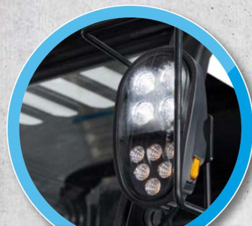
Sicherheitsbeleuchtungspaket bestehend aus 2 LED Arbeitsscheinwerfern, Warnblitz- und Rückleuchte
