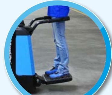
Die serienmäßige Mitfahrerplattform und die Seitenbügel lassen sich bei Bedarf einfach ausklappen.
