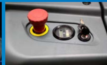
Mit Schlüsselschalter, Batteriestands- und Ladestandsanzeige mit Betriebsstundenzähler
