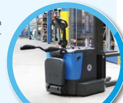
Durch die praktische klappbare Mitfahrerplattform und die Seitenbügel lassen sich die Geräte sowohl als Mitgänger als auch als Mitfahrergerät benutzen
