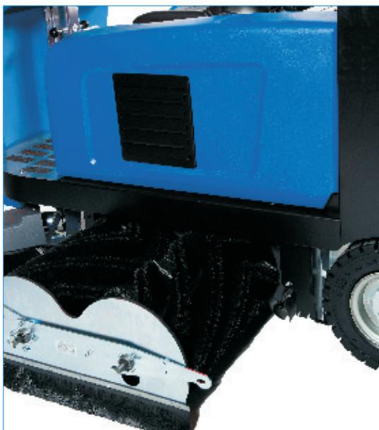
Werkzeugloser Wechsel von Walzen und Filtern - für weniger Wartungsaufwand und bessere Effizienz.
