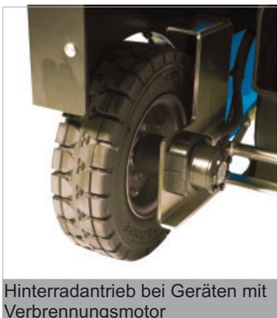
Hinterradantrieb bei Geräten mit Verbrennungsmotor
